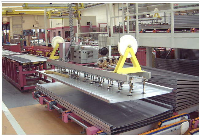
Плоские присоски PFYN VU1, используемые для перемещения крупных деталей из листового металла
